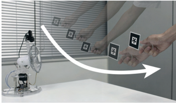
図 3. AirWand: 風を操るように、空間中で送風のパスと ON/OFF を制御する。リモコンの表裏で ON/OFF.
